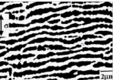
شکل ۵- تصویر SEM از درشت شدن جهت دار گاما پریم در یک سوپر آلیاژ پایه نیکل تک کریستال
