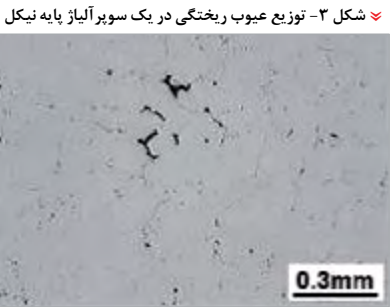
شکل ۲- توزیع عیوب ریختگی در یک سوپر آلیاژ پایه نیکل
