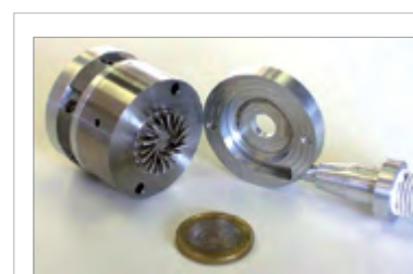
شکل ۴. قسمت های مختلف یک میکرو توربین (قطر روتور ۱۰ میلیمتر)
